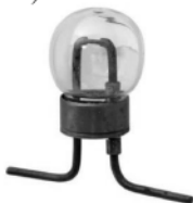
2-rasm: Lodigin ixtiro qilgan birinchi cho'g'lanma lampaning ko'rinishi.
